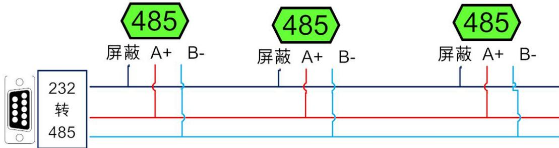
本产品默认使用RS485接口，配合电脑使用需要用USB转RS485转换器。A接A（+接+），B接B（-接-），组网时尽量使用使用链型网络。
